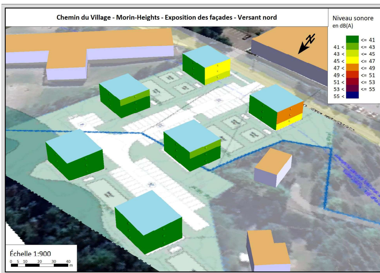
Figure 5: Exposition des façades au bruit- Versant nord
